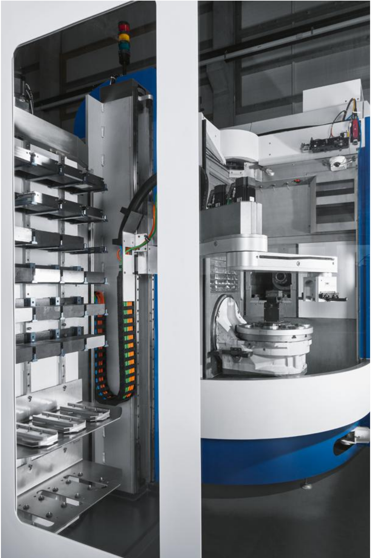
Zrobot 100 V: rozwiązanie automatyzacji z niezwykle elastycznym robotem ładującym do obrabiarek.
