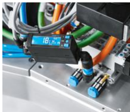
Czujnik przepływu SFAH szybko i precyzyjnie wykonuje pomiar ciśnienia wstępnego zaciskania zero point.
