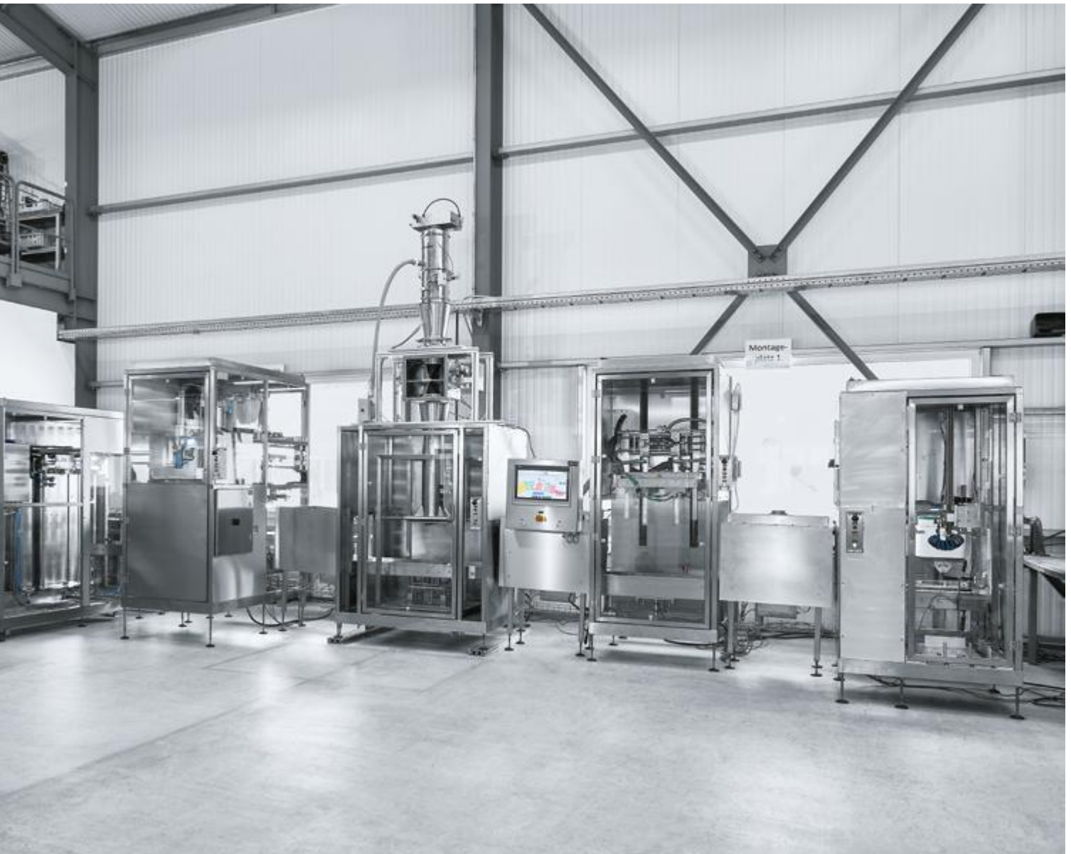
Większa produktywność zautomatyzowanego napełniania i higienicznego pakowania: kompletna linia opracowana przez firmę Burgener dla dodatków farmaceutycznych w formie sypkiej, w prosty sposób obsługuje złożone procesy. Ważną rolę pełnią w niej komponenty Festo.
