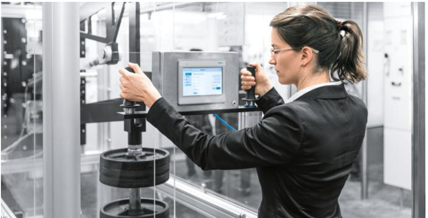
Niezwykle proste przenoszenie ciężkich ładunków: innowacyjna dźwignia generuje sygnał sterujący do poruszania systemem balansera.
